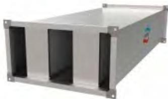
Пластинчатые шумоглушители «ШГ» предназначены для поглощения аэродинамического шума и различного рода вибраций в воздуховодах канальной системы вентиляции и кондиционирования воздуха. Шумоглушитель устанавливается по ходу движения воздуха в направлении указанном на корпусе стрелкой. Корпус шумоглушителя изготавливается из оцинкованной стали с поглощающим материалом из минерального волокна.
