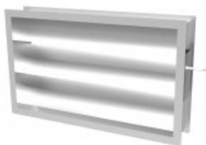
Воздушные клапан-жалюзи прямоугольного сечения предназначены для регулирования расхода воздуха и закрытия воздуховодов. Конструктивно клапан-жалюзи состоит из корпуса и установленных в нем жалюзи с резиновыми уплотнителями, которые через систему колес поворачиваются на требуемый угол. Крепление ручного или электрического привода к корпусу клапана-жалюзи осуществляется с помощью монтажной площадки.
